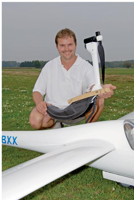
Konstruktionsprinzip herrscht heute bei Zweckmodellen vor. Bei vorbildgetreuen Nachbauten von Segelflugzeugen wirkt diese Klappflugschraube an der Rumpfspitze allerdings alles andere als realistisch.
